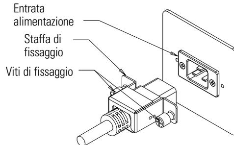
**Figura 1-12.** Cavo di Alimentazione Allegato
