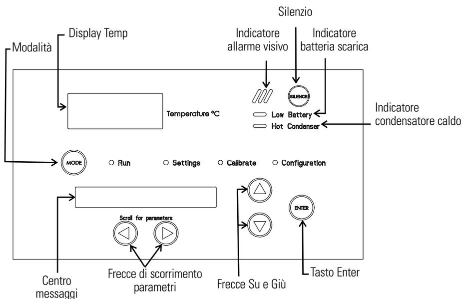
**Figura 1-9.** Tasti pannello di controllo, display e indicatori
